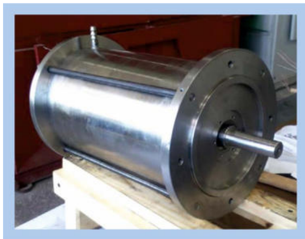
Рис. 1.15. Общий вид радиационно стойкого асинхронного двигателя ДАР-2.2
