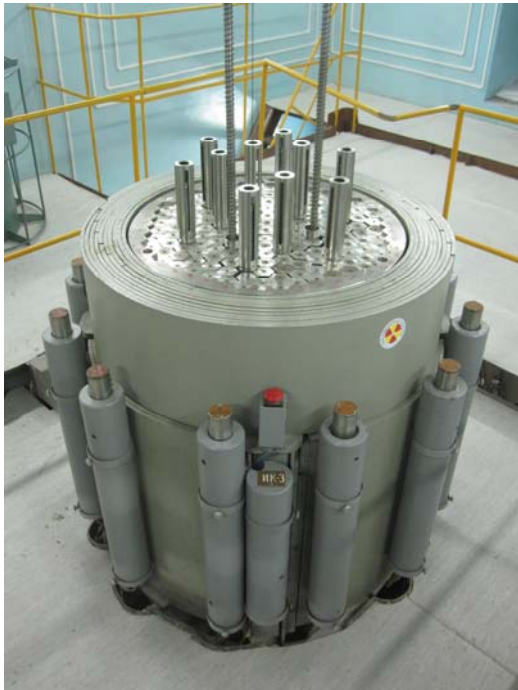
Рис. 3. Критическая сборка с гидрид-циркониевым замедлителем
