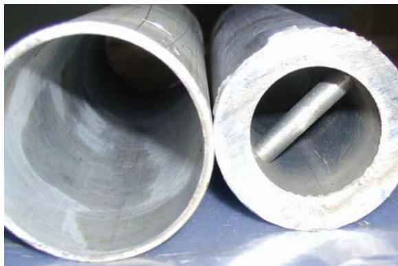
Рисунок 2. Фрагмент АМг5М-корпуса канала ВОТК в месте расположения втулки блока биологической защиты канала и фрагмент этой 12Х18Н10Т-втулки
